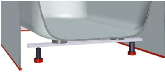
Die Trägerschiene und die schallisolierten, vertikal und horizontal verstellbaren Füße, werden werkseitig mit der Wanne fest verschraubt.
