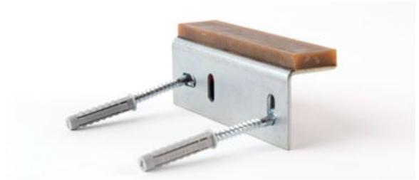
Niveau OK fertige Wanne bestimmen. Löcher für die Wandschienen anzeichnen und bohren, Dübel D 8 mm setzen, Wandschienen montieren und nivellieren. Das Auflager ist schallgedämmt und verhindert das Absenken des Wannenrandes.
